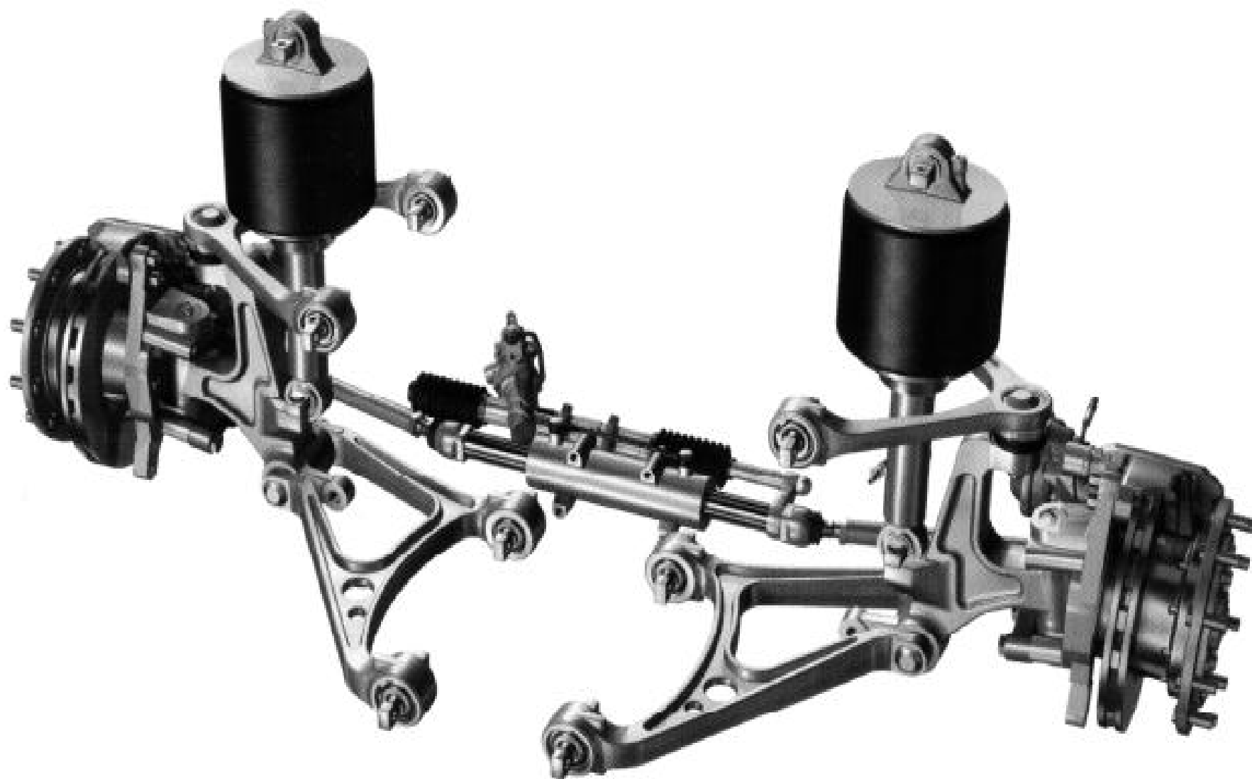
Dwuwahaczowe zawieszenie niezależne przedniej osi samochodu ciężarowego
