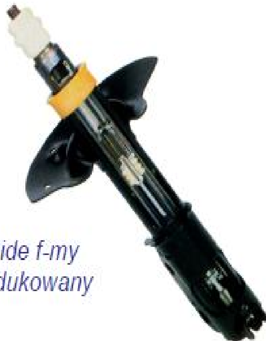
Idea amortyzatory magnetycznego na przykładzie Audi Magnetic Ride
