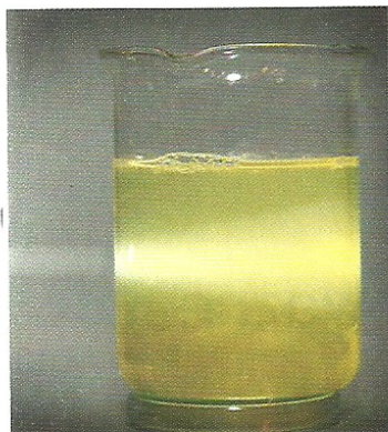
Fot. 44. W koloidzie pojedyncze cząstki substancji rozpuszczonej są na tyle duże, że rozpraszają światło.
