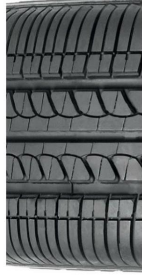
Bieżnik symetryczny w oponach Bridgestone B250
